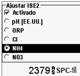
**Activado** le permite activar o desactivar la función ISE y seleccionar qué sensor ISE se instala en el cable.
